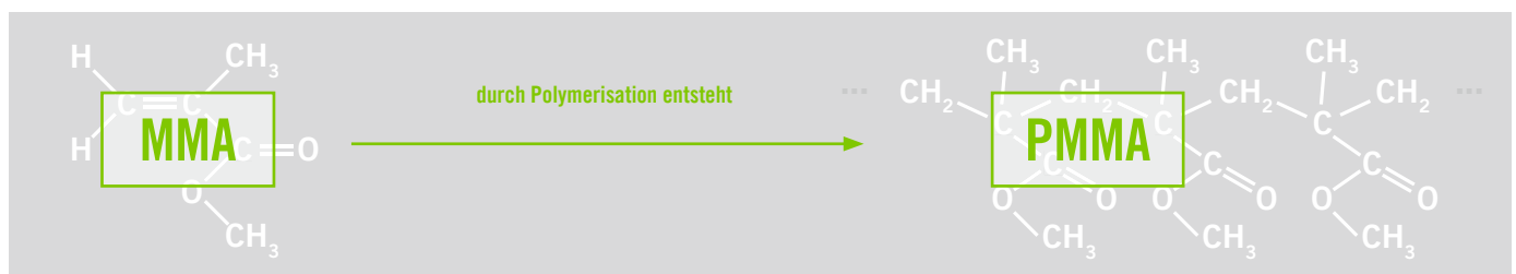
Abb. 1. Monomeres Methylmethacrylat (MMA) polymerisiert zu Polymethylmethacrylat (PMMA).
